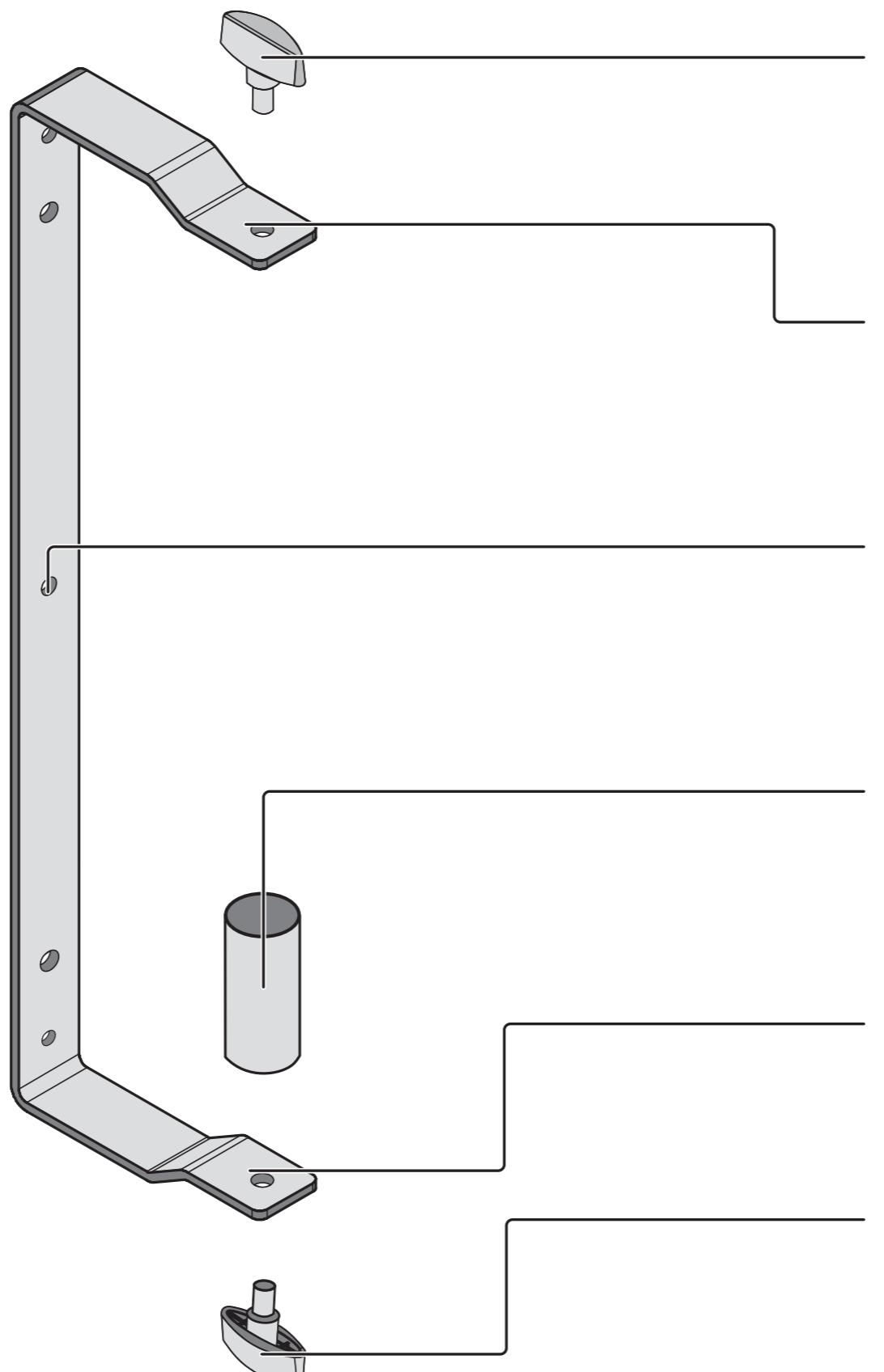
**FISSAGGIO SUPERIORE GIREVOLE** Si avvita attraverso la staffa superiore in un foro filettato nella parte superiore dell'altoparlante della serie B200. Fissa l'altoparlante in posizione.
