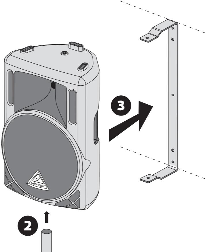
**[SE]** Sätt i MOUNTING POLE i polmonteringsuttaget längst ner på B200-seriehögtalaren.
